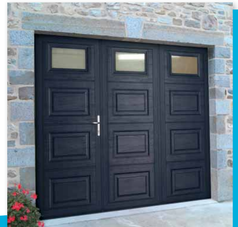
Porte 3 vantaux, gamme OXALYS . Panneau acier, finition Woodgrain, cassette. Vantail de service : vantail gauche. Ouverture vers l'intérieur de série. En option : hublots n°1 aluminium thermolaqués.
